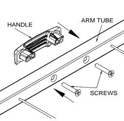
INSERT THE SCREWS INTO THE BACK OF THE ARM TUBE. ENSURE THAT THE HANDLE IS ON THE OUTSIDE FACE OF THE ARM TUBE. LOGO MUST BE UPRIGHT. PLACE THE HANDLE ONTO THE ARM TUBE & TIGHTEN UP THE 2 SCREWS.
